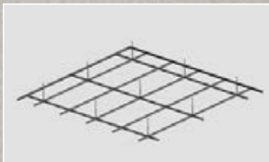
A / Listajärjestelmän asennus (valinnainen) Asenna Chicago Metallic™ Monolithic -listajärjestelmä.
